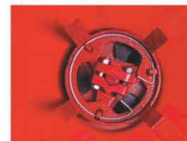
The stirrer features an "oscilating" system. (fig. 2) El agitador pose sistema oscilante. (fig. 2)
